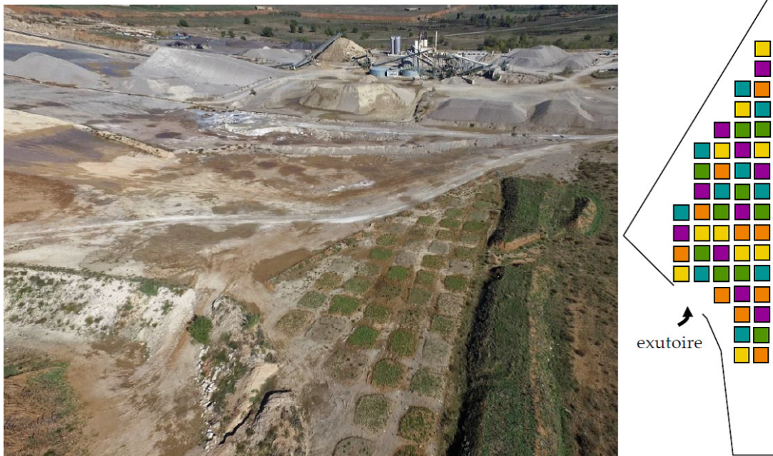
Vue aérienne et schéma du dispositif expérimental des différents types de technosols testés (Photo SCLM et montage Chenot, IMBE-Gagneraud)
